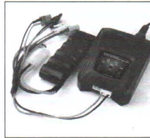
Схема подключения батареи Ni-MH/Ni-Cd
